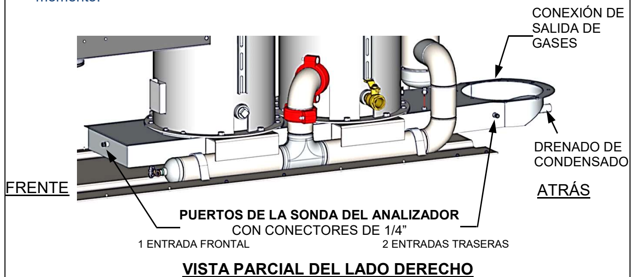
Figura 4-2: Ubicación de los orificios para la sonda del analizador
